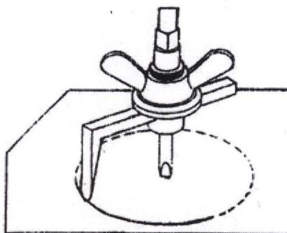
При монтаже панелей «Нофламат», «Гипласт» мы рекомендуем использовать круговую дрель или специальный резак, чтобы прорезать отверстия под установочные элементы.
